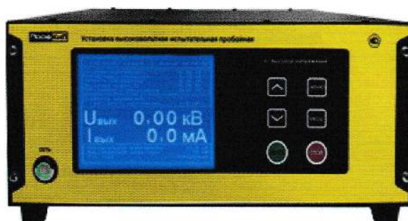
Рисунок 2 – Общий вид модификаций УПУ-22, УПУ-200, УПУ-300, УПУ-500
