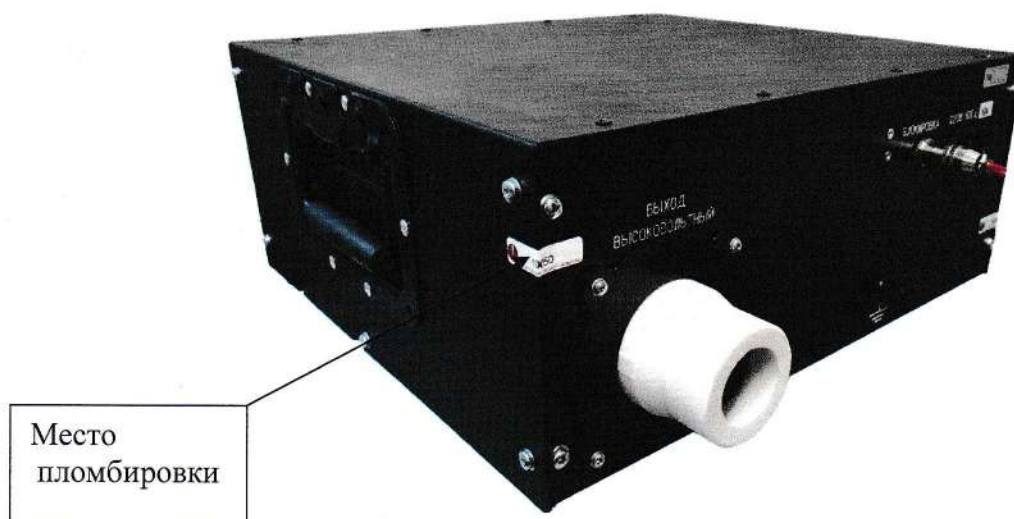
Рисунок 3 – Схема пломбировки установок от несанкционированного доступа
