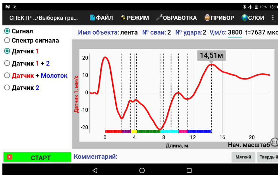
Рисунок 2 - Окно приложения прибора с примером сигнала.
