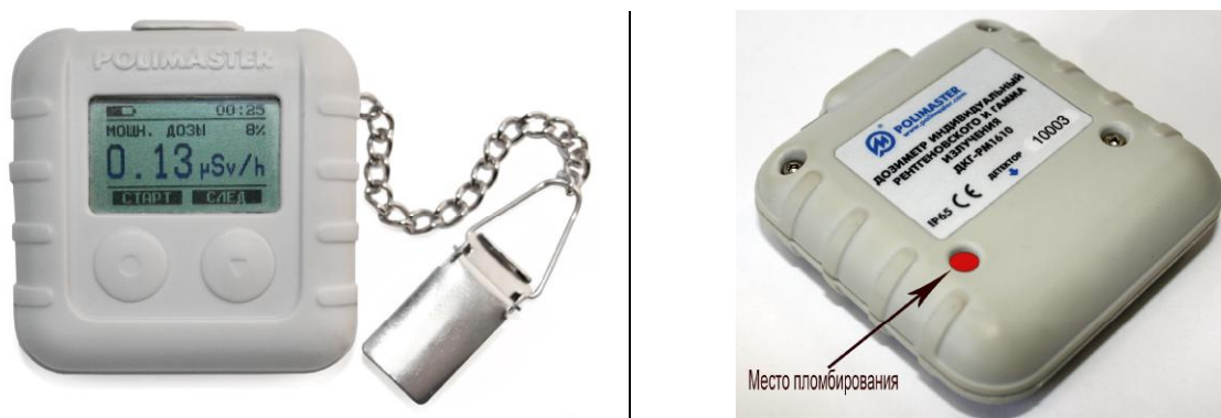
Рисунок 1 – Общий вид дозиметра индивидуального рентгеновского и гамма излучения ДКГ-PM 1610
