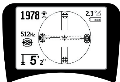
Рис. 28: Поиск зонда: экватор
